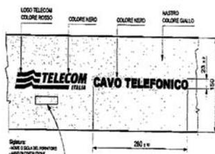
**Nastro segnalatore** di cavi e manufatti TI nel sottosuolo.
