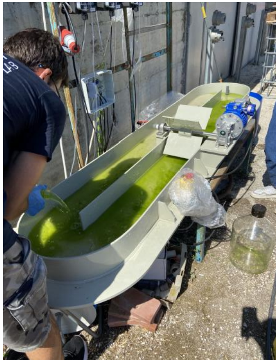
Figura 6 - Reattore a microalghe (HRAPs)
